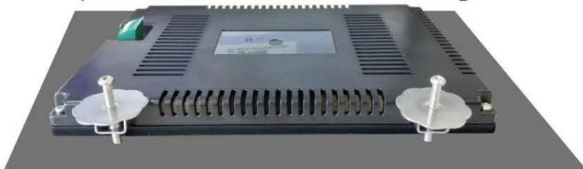
第三步：旋紧螺丝，将HMI固定在设备上。
