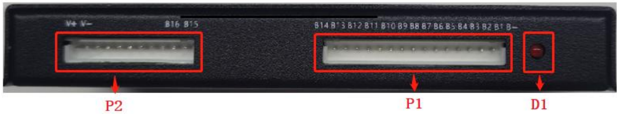
JK-B1A16S-TH 连接器示意图 Schematic diagram of the JK-B1A16S-TH connector
