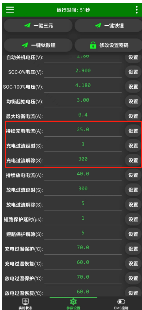
图5 APP设置保护板控制JK-BLMK-5A模块
