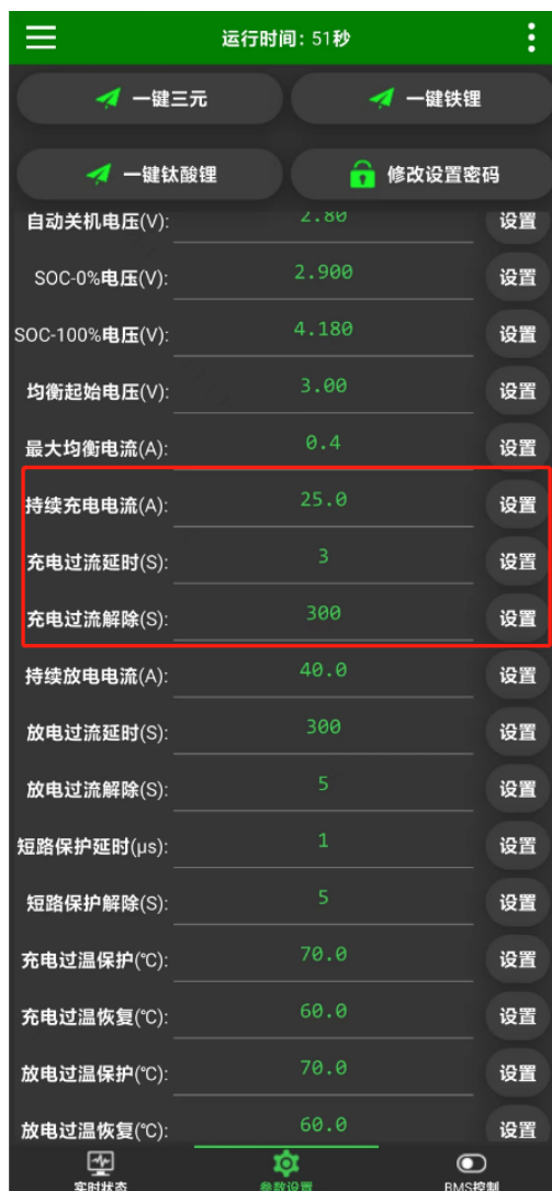
图5 APP设置保护板控制JK-BLMK-5A模块
